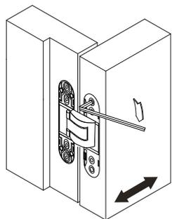
2 Отрегулировать глубину, повернув болт С в двери
