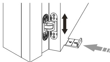
**1** Вставить регулировочный клин (не входит в комплект) под дверь и освободить ход петли, выкрутив два шурупа B в двери; дверь сядет на клин
